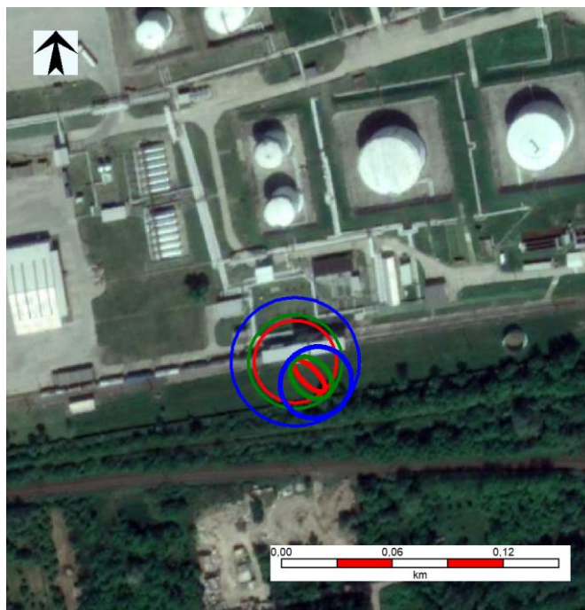
6.3.5.6.3.3. ábra F2 baleseti eseménysor - Jettűz – hőszugárzás
